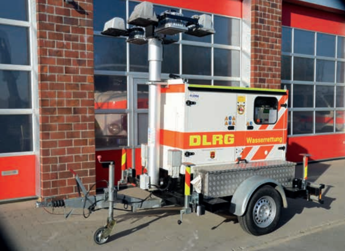
Lichtmast mit Stromnetz-Ersatzanlage der DLRG Horneburg.
